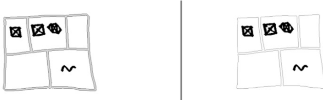
Рис. 5. Слева – после выделения границ; справа – после исключения внешней границы
