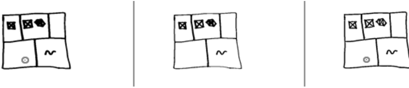
Рис. 3. Слева – после глобального порога со значением 50; в центре – после глобального порога со значением 30; справа – после адаптивного порога (изображения после гаусс. ф.)
