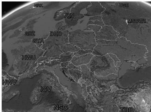
Рис. 1. Расположение европейских СДВ-радиопередатчиков (MSCW1 – радиоприемник в Москве)
