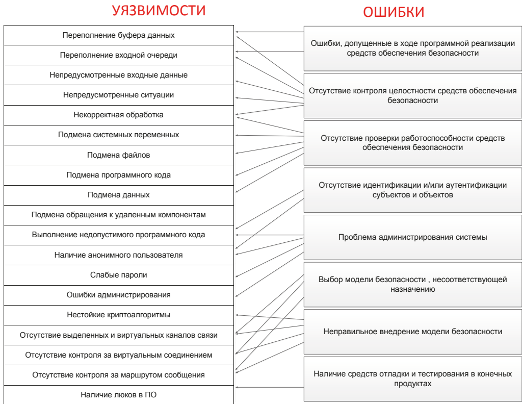
Рис. 3. Сопоставление уязвимостей компонентов вычислительной системы и ошибок, допущенных на различных этапах ее создания
