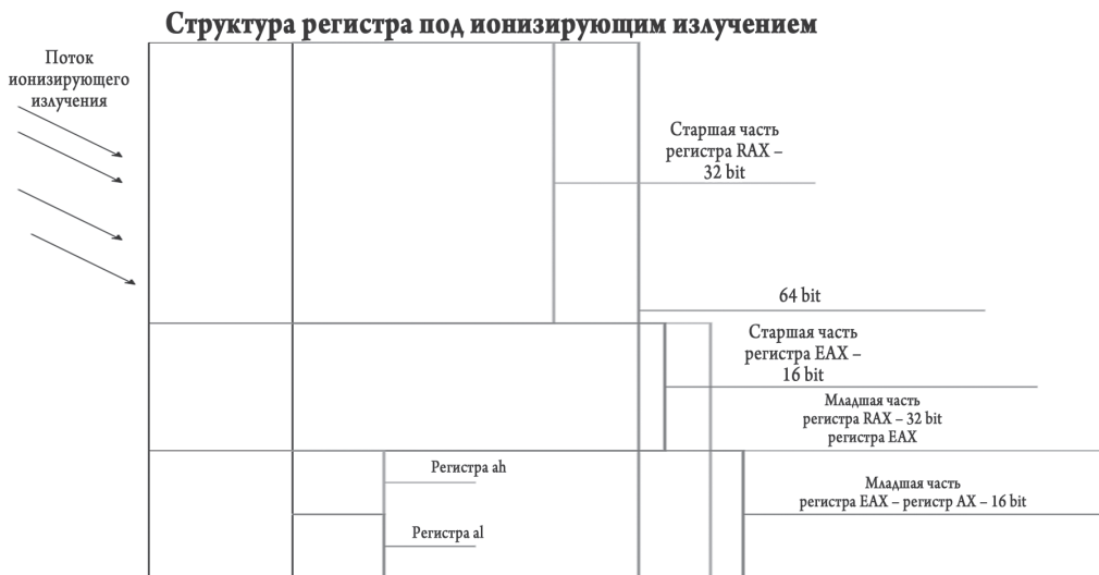
Рисунок 7. Логическая структура регистра RAX под воздействием ионизирующего излучения
