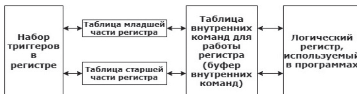
Рисунок 3. Краткая структура работы табличного регистра для микропроцессора выбранной архитектуры
