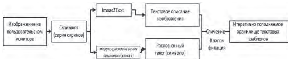
Рисунок 1. Этапы обработки пиксельного изображения на дисплее пользовательского ПК средствами СПО демонстратора
