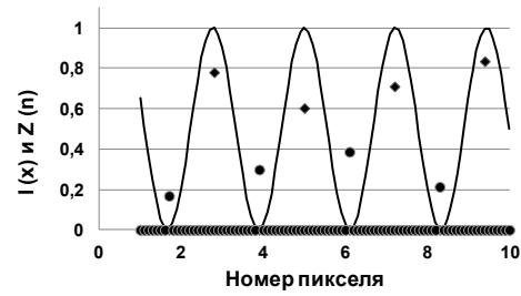
Рис. 9. Интенсивность облучения ПЗС через синусоидальную миру с пространственной частотой \nu = 0,9 / (2\Delta) (сплошная линия); максимальные значения сигнала (ромбы); минимальные значения сигнала (круглые маркеры)
