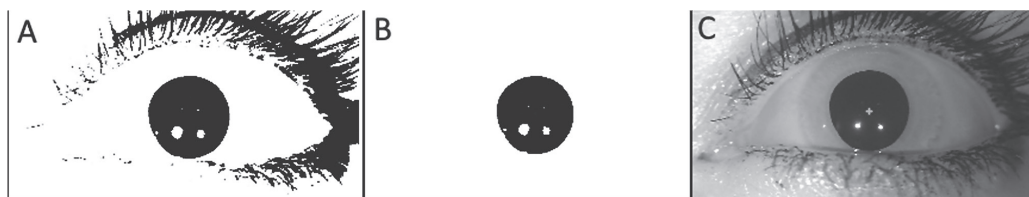
Рисунок 3. Проверка размаха кластера: А – результат бинаризации; В – результат фильтрации с учетом размаха кластера; С – найденный центр зрачка
