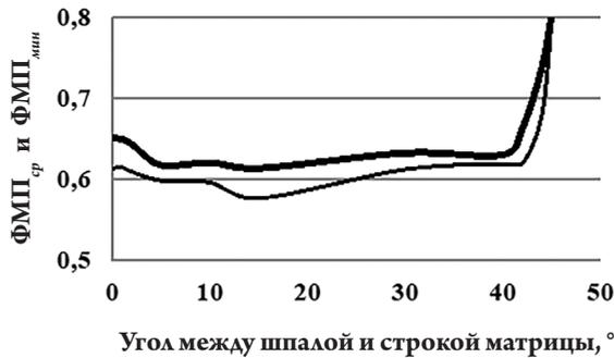
**Рис. 15.** Резонансные всплески значений ФМП при ширине шпалы мира, равной 1,4 размера пикселя, и при углах наклона шпалы мира по отношению к строке матрицы, равных  $0$  и  $45^\circ$ : толстая линия – средние значения ФМП; тонкая линия – минимальные значения ФМП
