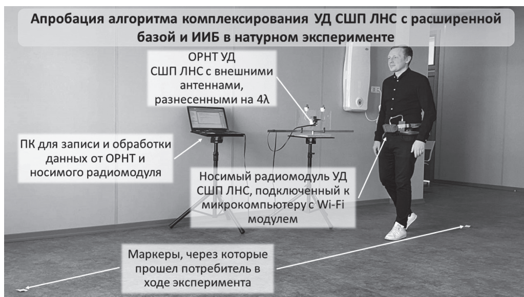
Рисунок 10. Схема натурного эксперимента для валидации и оценки точности разработанного алгоритма комплексирования носимого радиомодуля УД СШП ЛНС, ИИБ и магнитометра
