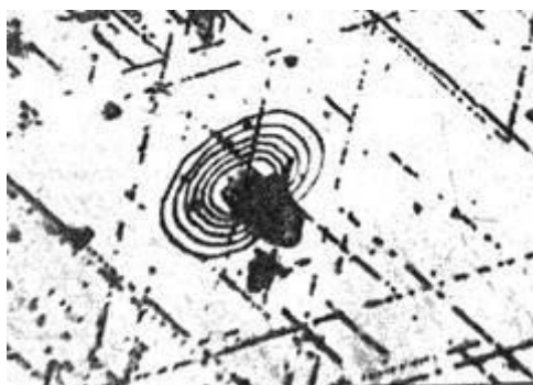
Рис. 9-а. Источник Франка – Рида в сплаве нимоник 80А. Фото под оптическим микроскопом
