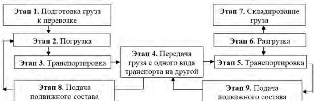
Рисунок 2. Технологическая схема транспортной перевозки грузов несколькими видами транспорта
