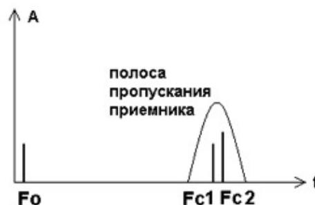
Рис. 4. Частотный план сигналов
