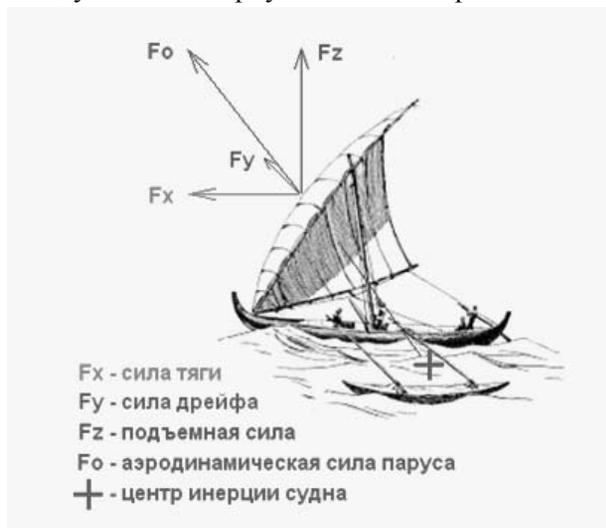
Рис. 13. Разложение сил на парусе проа
