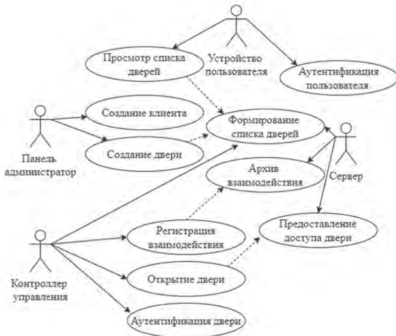
Рисунок 3. Диаграмма вариантов использования программно-аппаратного комплекса
