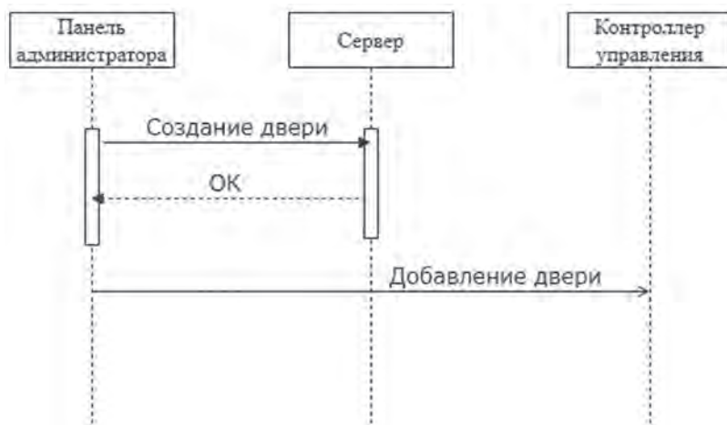
Рисунок 4. Инициализация точки входа-выхода
