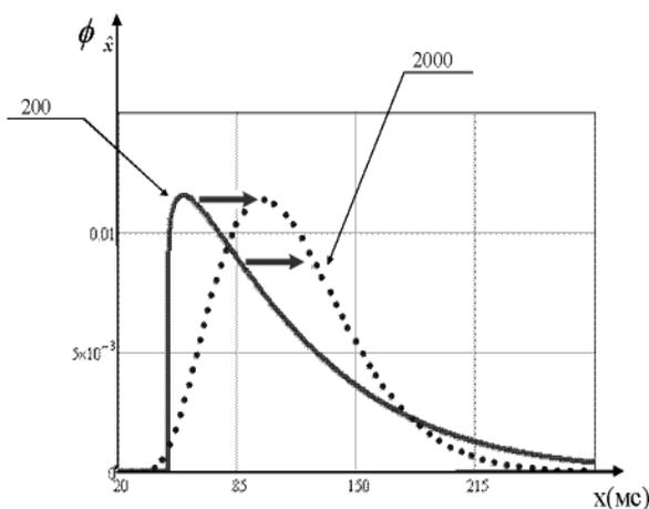
Рис. 3. Уточнение плотностей распределения СВел при продолжительности нажатия клавиши при фиксации 200 и 2000 нажатий
