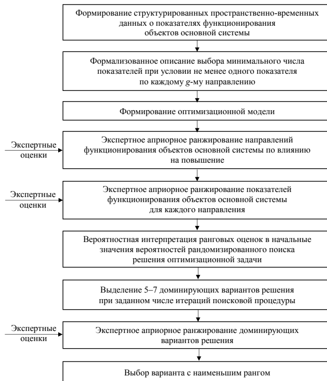
Рис. 2. Структурная схема алгоритма интеллектуальной поддержки управления выбором показателей по влиянию на повышение рейтинга объекта основной системы
