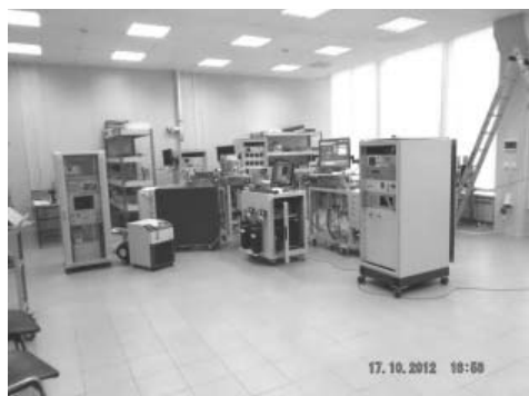
Рис. 1. Общий вид открытой МКНТУ. Технологические, аналитические, транспортные модули [1–3, 10–13], ПС управляющих компьютеров которых объединены в промышленную ЛВС RS-485
