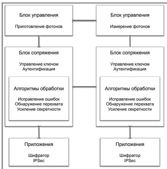
Рис. 1. Структурная схема устройства квантовых коммуникаций
