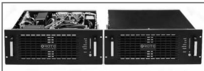
Рис. 2. Реализация устройства квантового распределения ключей
